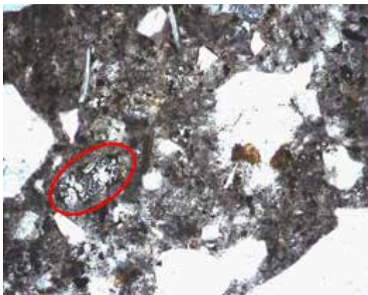
Fig. 26: La matrice della malta è composta da grani di clinker 1 non idratati (fasi anidre) e dal silicato di calcio idrato che si forma dall'idratazione di alite o belite presenti nell'impasto. Si tratta di una particolare varietà di C-S-H, che è una denominazione generica che indica un silicato di calcio idrato, amorfo o scarsamente
